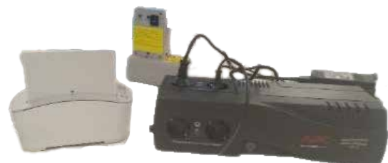
Cargadores de batería para generador y detector Delft Light
