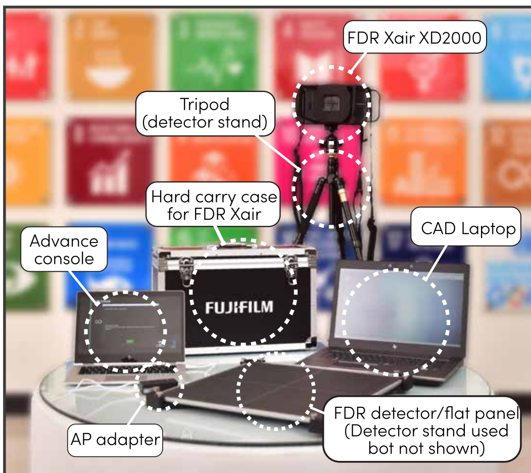
Figura 12 Sistema central Fujifilm FDR Xair etiquetado. Imagen cortesía de DOPASI
